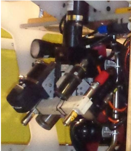
Fig. 4. Het camera systeem op de ROV met de 2 NIOZ lasers. De hoek met de horizon (bodem) is ongeveer 45 graden.
