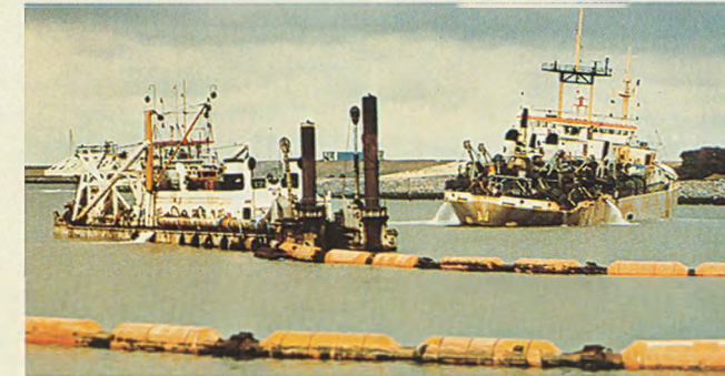
Een sleephopperzuiger lost in zee gewonnen zand vóór een cutter-zuiger die het opbaggelt en wegperst naar het strand.
