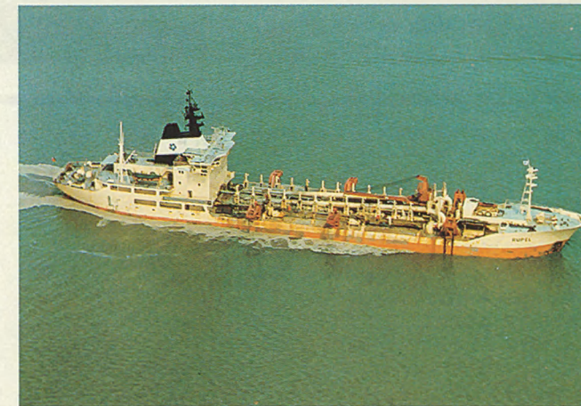
Sleephopperzuigers baggeren de bestaande geulen naar een breedte van gemiddeld 750 meter en tot op een diepte van gemiddeld 13,5 meter onder laagwater.
