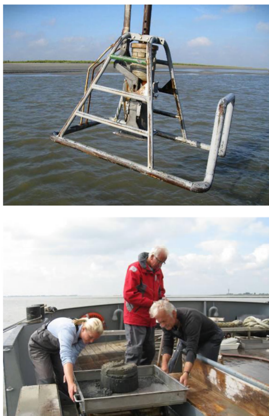
Figuur 9: Monsternamen met Reineck box-core aan boord van het onderzoeksschip Luctor, zeven van sediment cores voor macrobenthos
