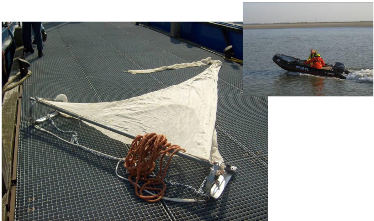
Figuur 10. De 2m boomkor getrokken door een kleine boot.
