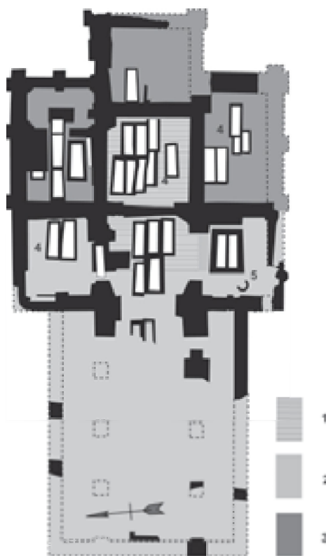
Afb. 5. Plattegrond van de kerk van Hannekenswerpe met zijn bouwfasen. Het teruggevonden muurwerk is in zwart aangegeven, met stippenlijnen is de reconstructie van de plattegrond aangevuld. Schaal 1:200. Legenda: 1. Kapel, midden twaalfde eeuw; 2. Romaanse kruiskerk, laatste kwart twaalfde eeuw; 3. Uitbreidingen in baksteen, dertiende eeuw; 4. Grafkelders; 5. Klokform (tekening: R. de Nennie naar Van Hinte 1963-1964).
