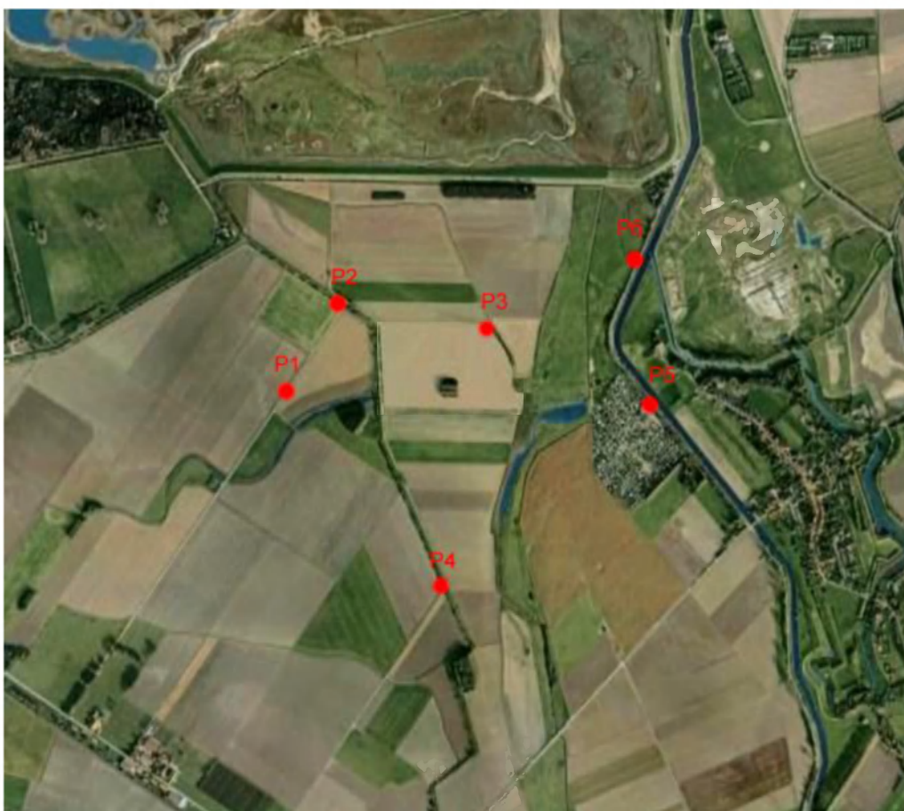
Figuur 2.1. Positie van de zes geplaatste boringen.
