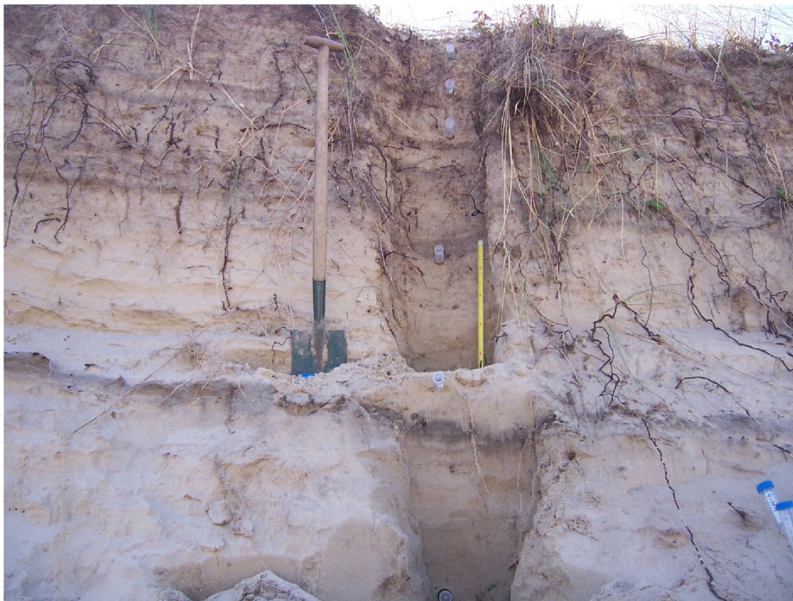
Figuur 2.9. Impressie van de bemonstering via een steilwand in stuifkuil, op meetpunt 710 te Bergen aan Zee. Het profiel vertoont een successie van vele overstoven duinbodems.
