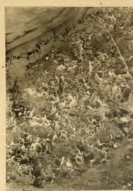
FIG. 2. — Calcaire à Stylolithes. — Viséen (V 2 b). Grands-Malades. — Plaque 255. — Grandeur naturelle. — Calcaire carbonifère. Collections du Musée de Bruxelles.
