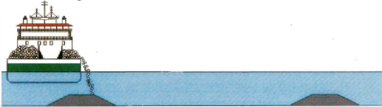
Aanbrengen van de steenbestorting
