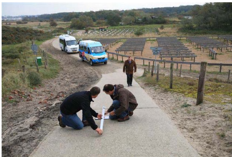
Figuur 7.1 Hellingshoek meten duinovergang Schouwen-Duiveland
