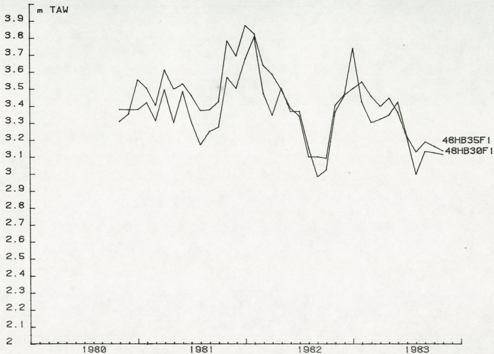
Fig. 4.16 - Zandpanne - centraal gedeelte : seizoenfluctuaties waargenomen in diepe piëzometers (laag A)
