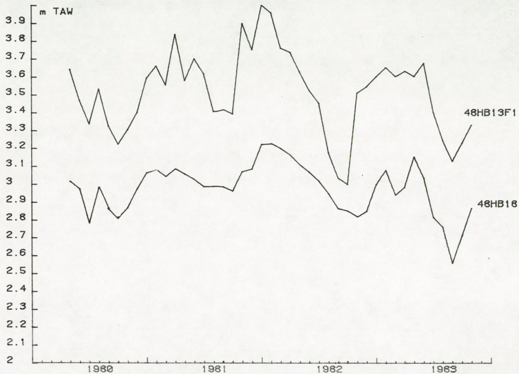
Fig. 4.29 - Zuidelijke duinrand : seizoenfluctuaties waargenomen in een ondiepe piëzometer (laag B : 48HB13F1) en in een diepe piëzometer (laag A : 48HB18)
