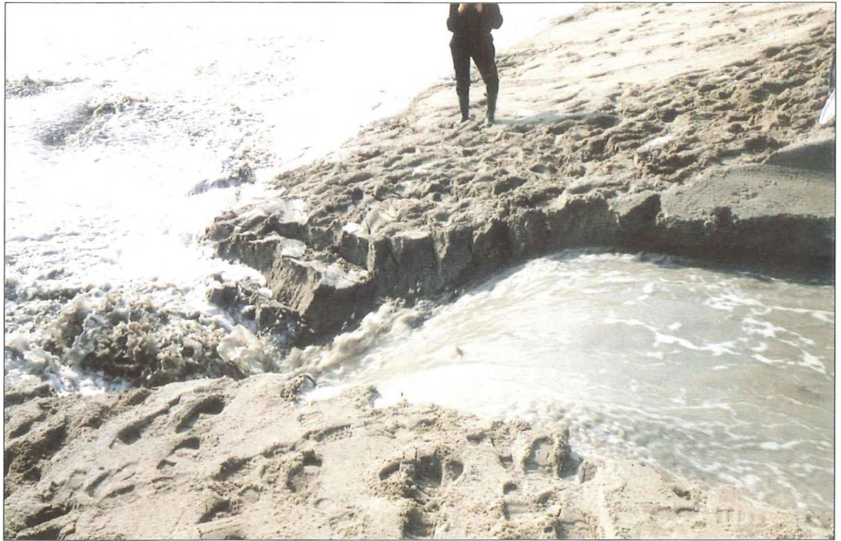
Figuur 3 Versteiling van het binnentalud tijdens fase 1
