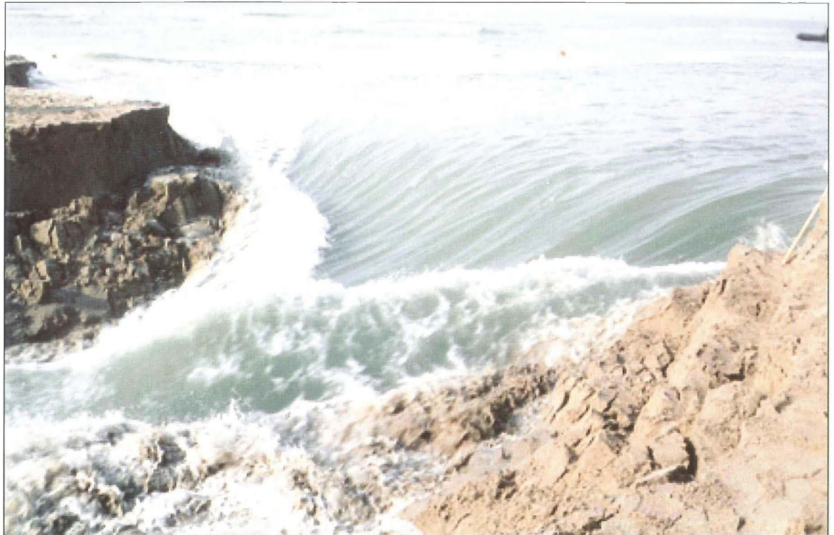
Figuur 5 Verdieping van de bres in fase 3
