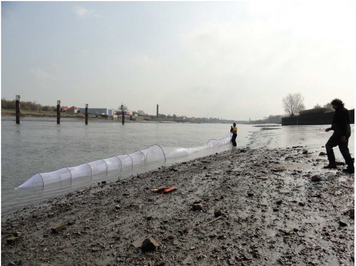
Figuur 2: Dubbele schietfuisen in de Rupel nabij Boom. De netten staan 24 uur op de laagwaterlijn waarna ze worden leeggemaakt. De vissen worden ter plaatse geïdentificeerd, geteld en gemeten. (Foto: Yves Maes, 2010)
