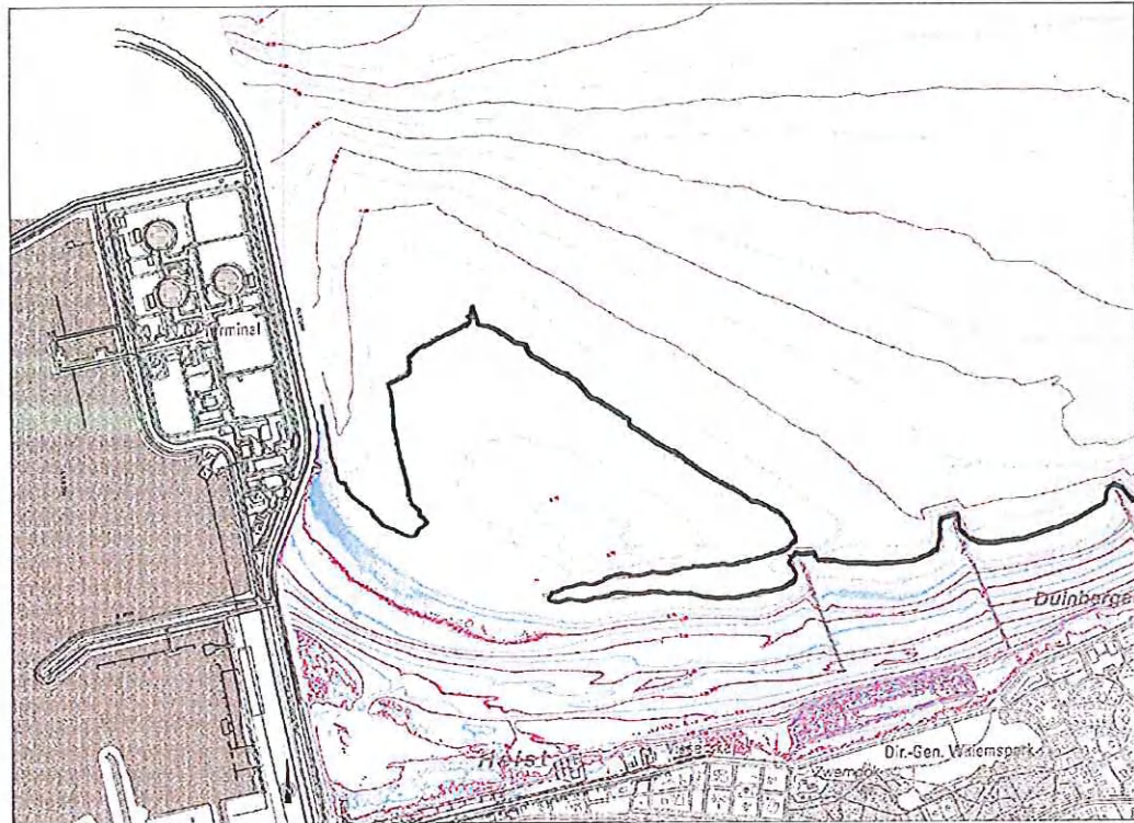
Figuur 4: Vooroeverlodingen uit mei-juni 2009, de zwarte contour geeft de 0 m TAW lijn (=ruwweg de laagwaterlijn). Verschil tussen twee opeenvolgende contouren bedraagt 0,5m
