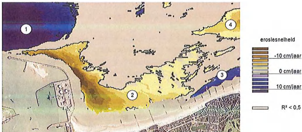
Figuur 6: Resultaat studie dieptekaarten vanaf 1986 → Erosie-/sedimentatiekaart – 1) Erosiezone ingang haven – 2) Aanzanding baai van Heist - 3) Erosie in Appelzak – 4) Aanzanding Paardenmarkt
