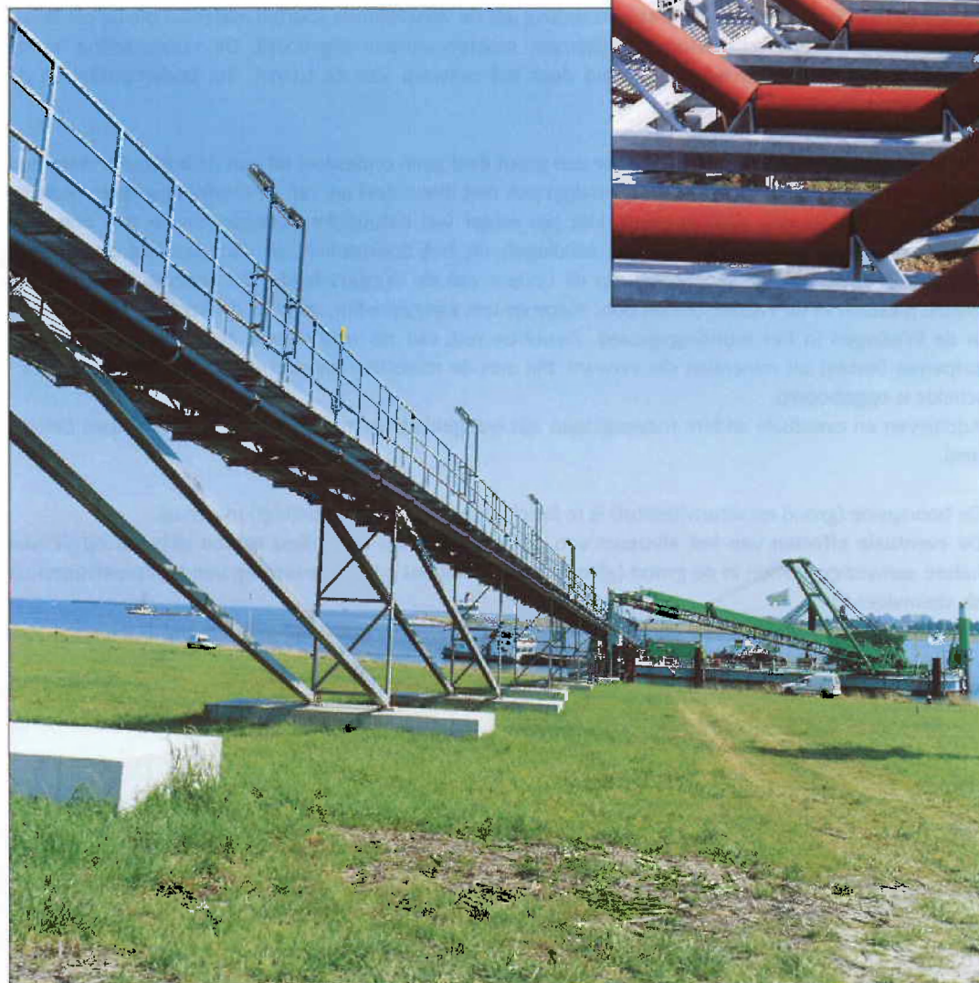
Loswal en transportband voor aanvoer grondstoffen naar de Betonwarenfabriek.
