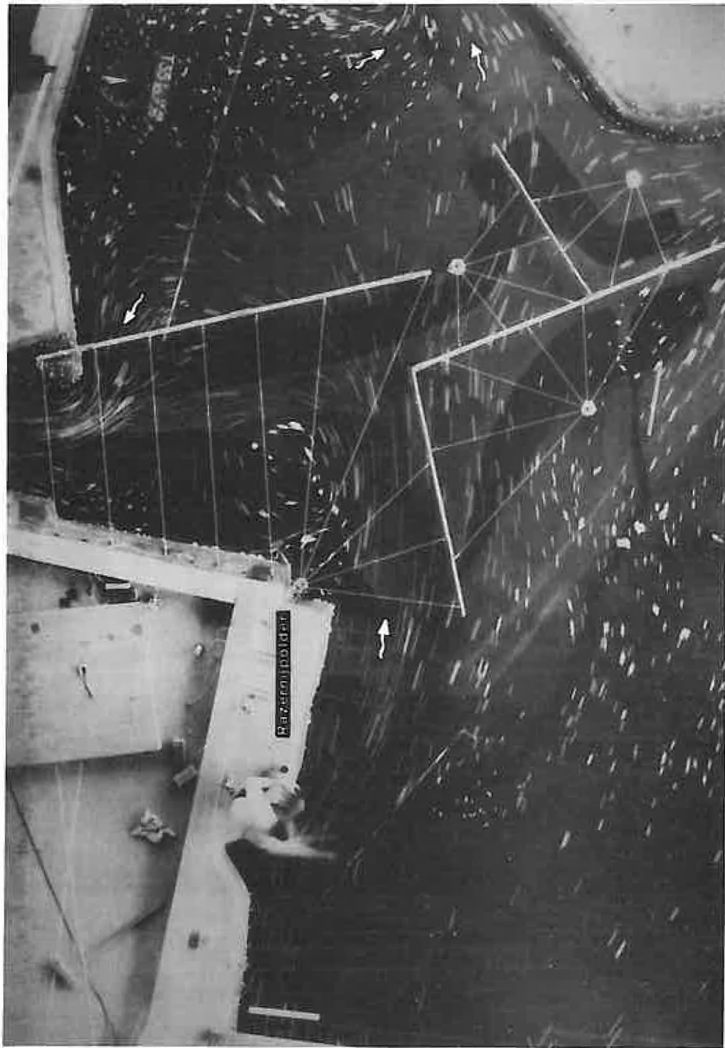
6. T35 hoge vloed, 17.30 uur Oppervlactestroombeeld bij de Razernijpolder Lengteschaal 1 : 20.000 Snelheidsschaal 1 cm \hat{=} 1,67 m/s
