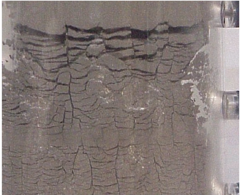
Figuur 13 Ijslens en scheuren in Zuid Polder klei (ZPK-1)
