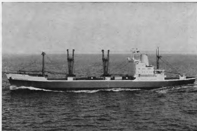
m.s. MONTENAKEN. Vrachtschip. Draagvermogen : 16.562 ton. Lengte : 161 m.
