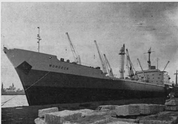
m.s. MONSOON. Vrachtschip. Draagvermogen : 16.600 ton. Lengte : 169,65 m.
