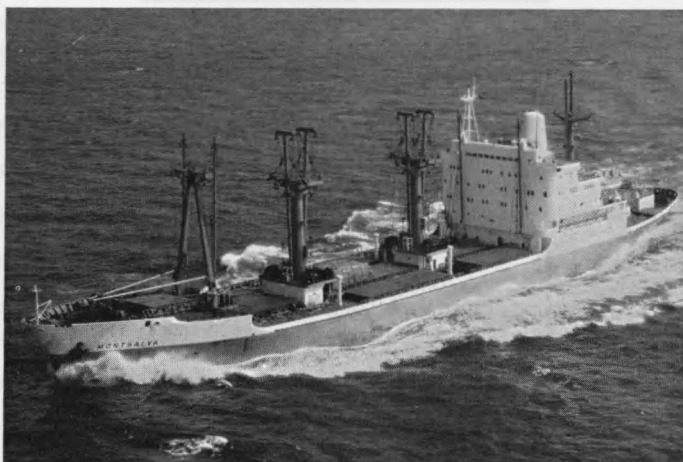
m.s. MONT SALVA. Vrachtschip. Draagvermogen : 16.550 ton. Lengte : 160,8 m.
