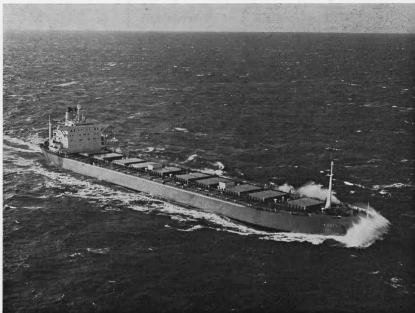
m.s. KYOTO. Bulkvrachtschip. Draagvermogen : 65.085 ton. Lengte : 224 m.
