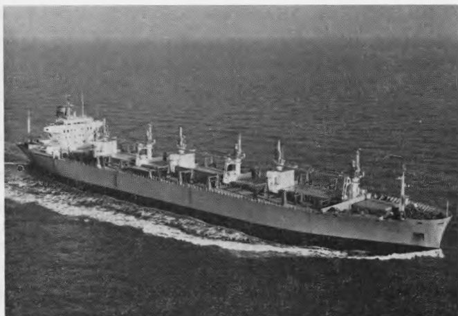
m.s. TITUS. Multipurpose schip, speciaal ontworpen voor het transport van auto's en tractors. Draagvermogen : 31.840 ton. Lengte : 185,8 m.
