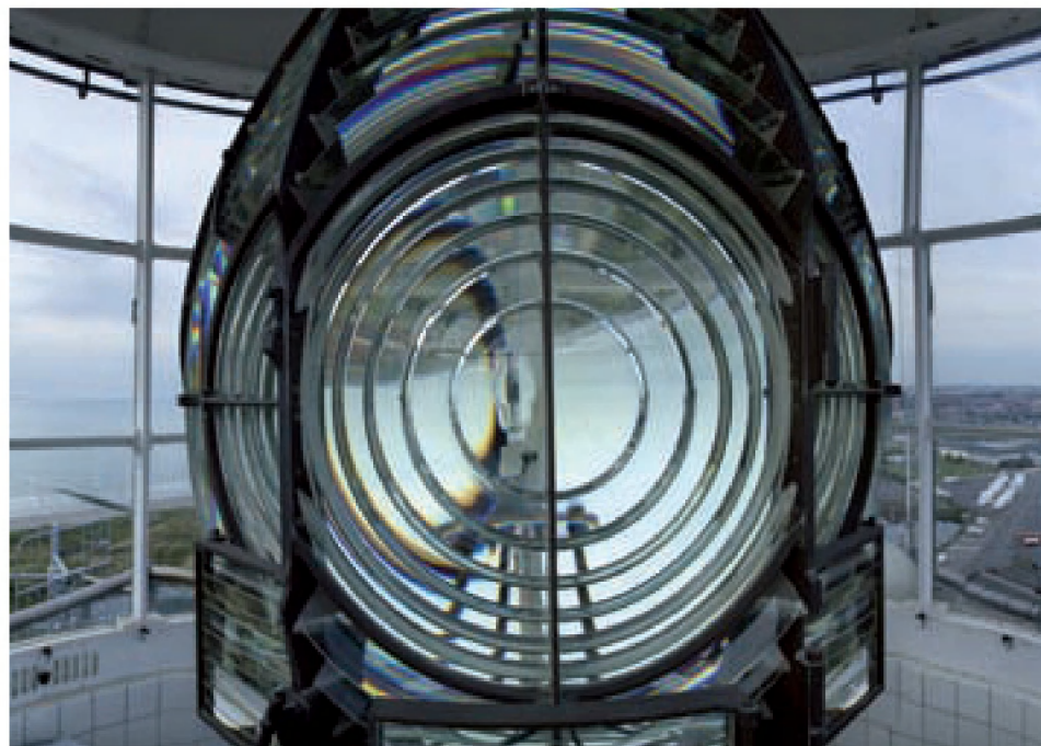
■ Deze Fresnel lens is vandaag nog steeds te zien in de Oostendse vuurtoren De Lange Nelle. Kenmerkend zijn de in ringen opgedeelde lensvlakken (MD)
