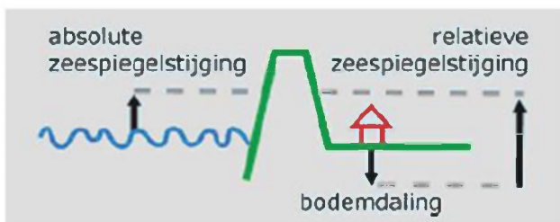
Figuur 2.26 Schematische weergave van het verschil tussen absolute en relatieve zeespiegelstijging als gevolg van bodemdaling
