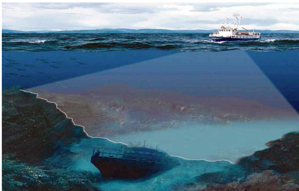
Figuur 8: Algemeen principe van een multibeam sonar (Bron: Kongsberg Maritime)
