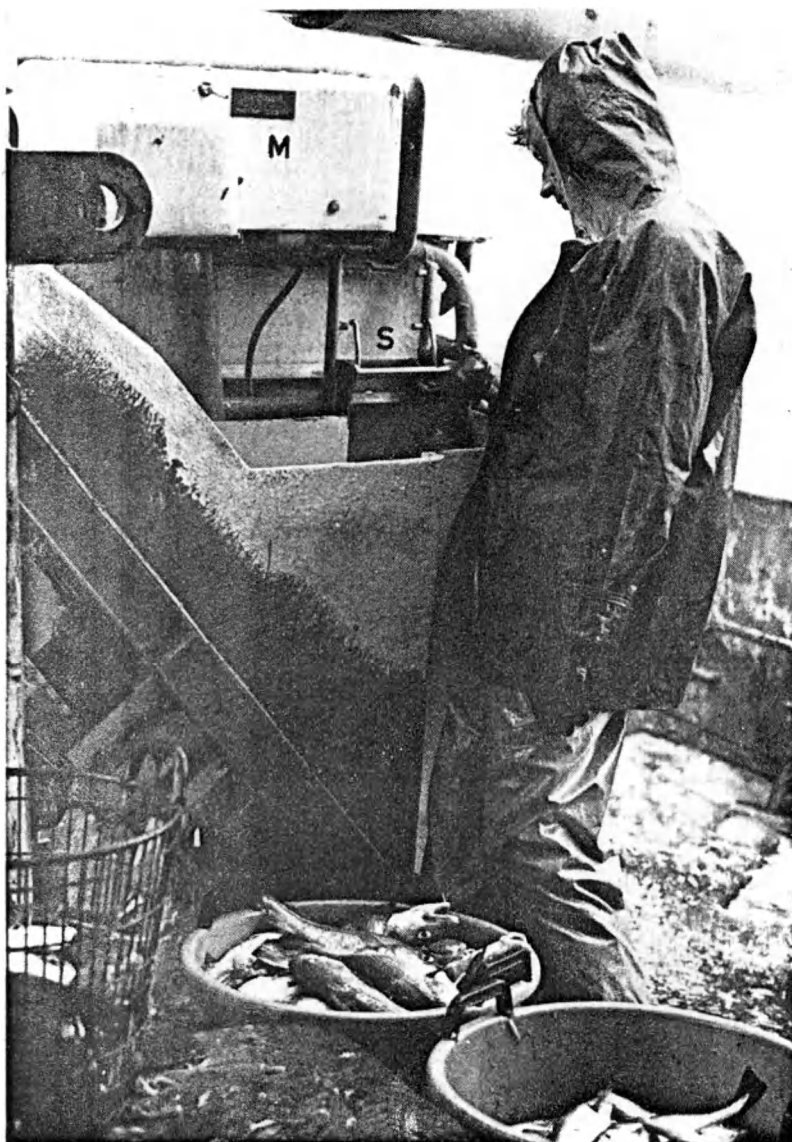
Figuur 9 — Transporteenheid van de automatische toevoer
