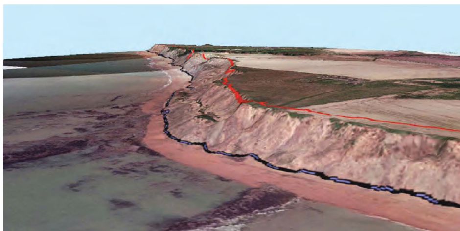
Figure 6.8: Simulation du retrait de la base de la falaise sur 50 années pour une partie de la côte sud-ouest de l'île de Wight au Royaume Uni.
