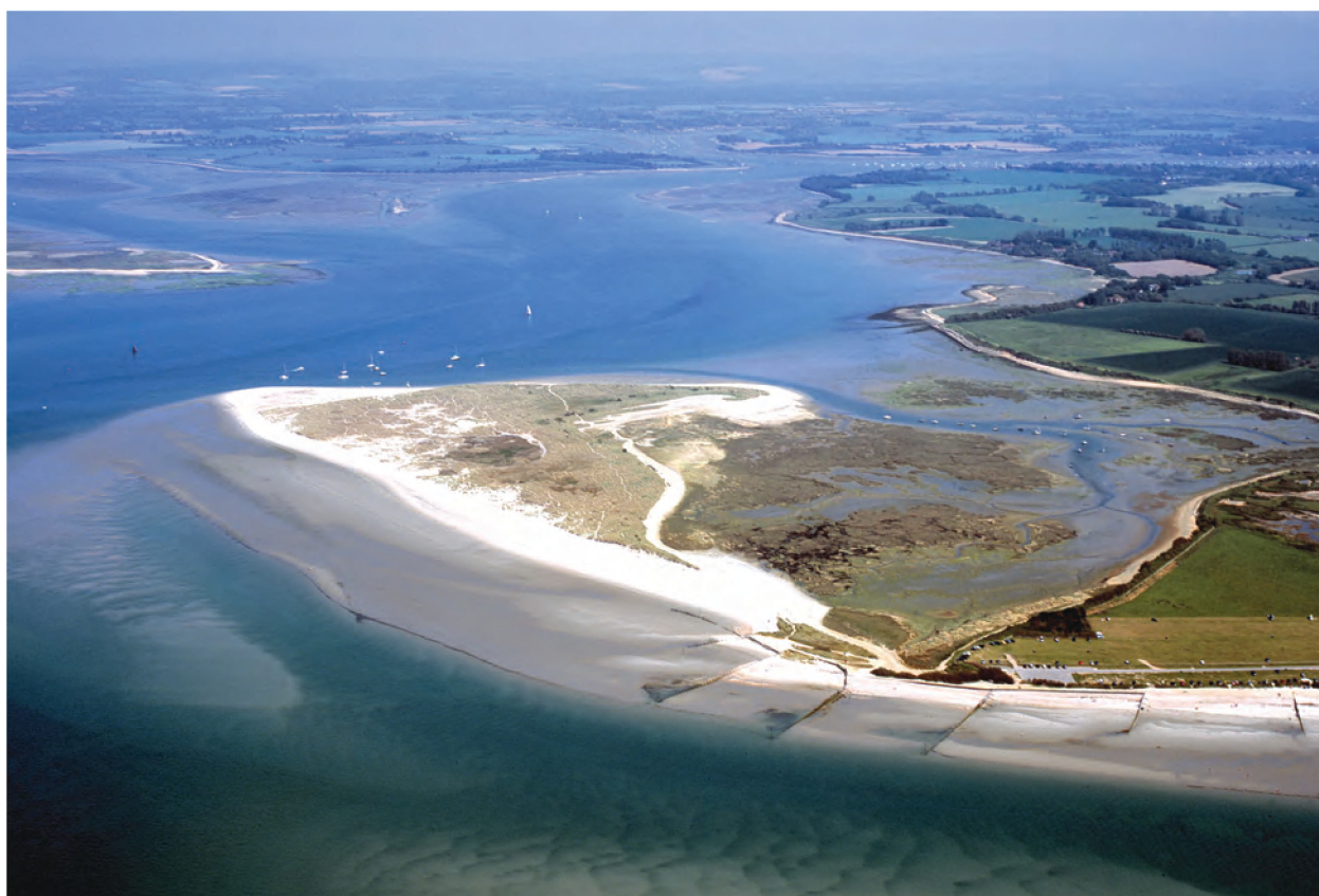
Planche 3.6: East Head auprès de Chichester, dans le Comté du West Sussex, Royaume Uni. Le risque auquel est exposé East Mead vient de l'érosion des dunes qui se trouvent à la jonction entre la pointe et les défenses en dur sur la côte. Si la marée ouvre une brèche, ceci pourrait gravement toucher le port intérieur et les chenaux de navigation.
