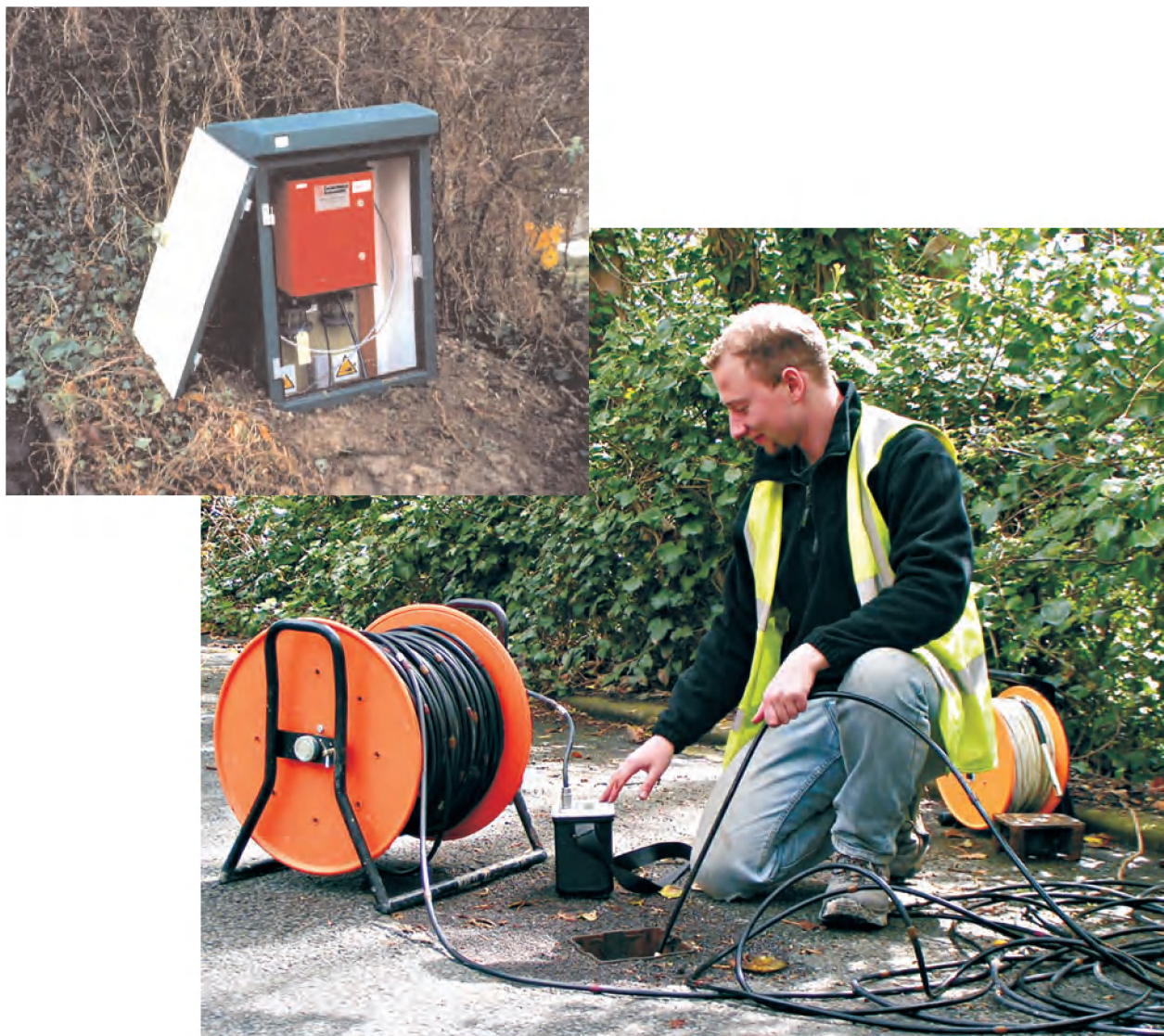
Planche 4.2: Relevés effectués sur un inclinomètre à Ventnor (Undercliff), sur l'Île de Wight ; une centrale de mesures (illustration) collecte des données de mouvement de terrain qui peuvent être téléchargées pour faciliter la gestion des risques de glissement de terrain.
