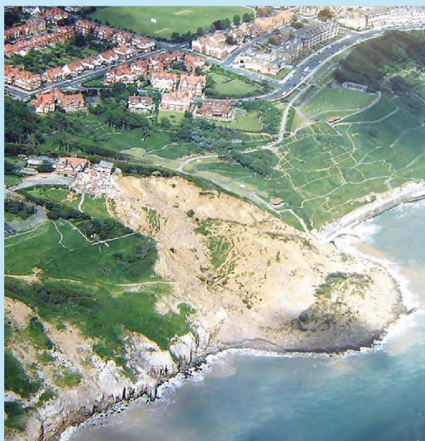
Cliché 19 : Glissement de terrain de Holbeck Hall, 1993, Scarborough, Nord Yorkshire, Royaume-Uni. Cette partie du système de glissement de terrain a été stabilisée.
