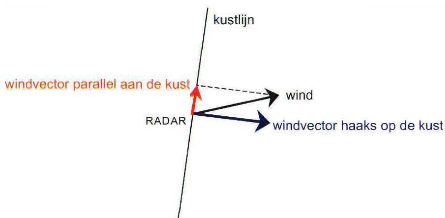
Figuur 25 Grafische voorstelling van de ontleding van de wind in een windvector haaks op de kust (blauw) en een windvector parallel aan de kust. In dit voorbeeld is een WZW wind ontleed in een positieve windvector voor vogels die zowel naar het O als het NNO willen vliegen. Dit is gunstig voor de voorjaarstrek. Merk op dat de wind veel gunstiger is om de Noordzee vanuit Engeland over te steken, dan langs de kust naar het NNO te vliegen. Maar voor beide vliegrichtingen bestaat een rugwind. Graphic presentation of wind vectors parallel (red) and at right angles to the coast (blue).
