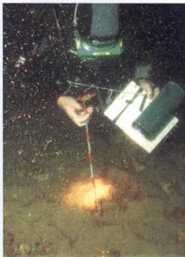
■ Wetenschappelijke duikers in actie: hier wordt de dikte van de zandlaag op de bodem bepaald. Deze meting is essentieel voor de karting van de bodem (KBIN)
