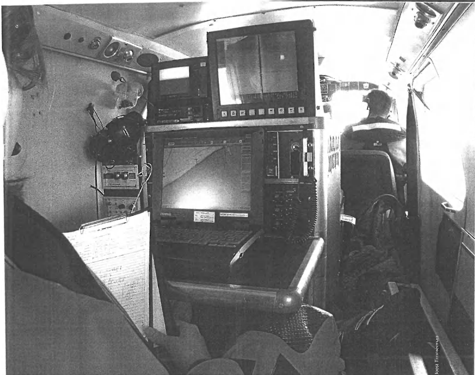
De Britten Normand Islander zit binnenin propvol detectieapparatuur die verbonden is met een gps systeem en een laptop.
