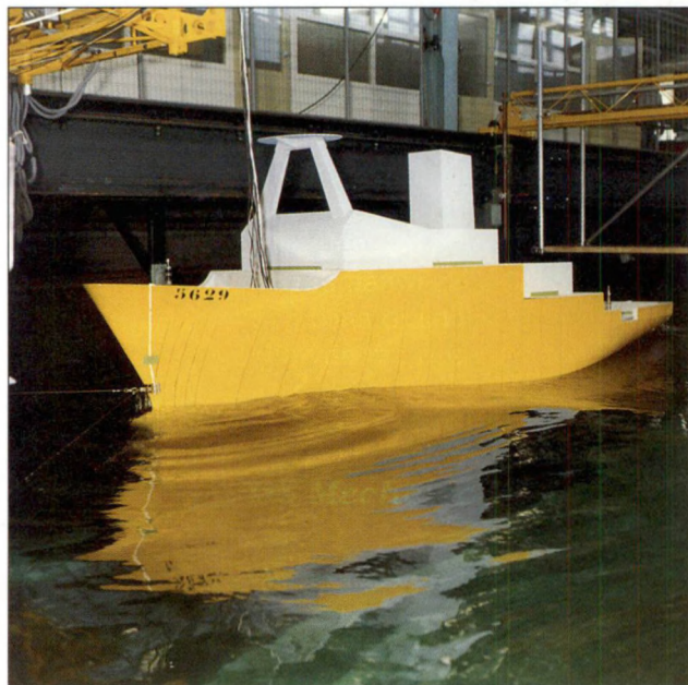
Technische proeven met een schaalmodel van de toekomstige Belgica
