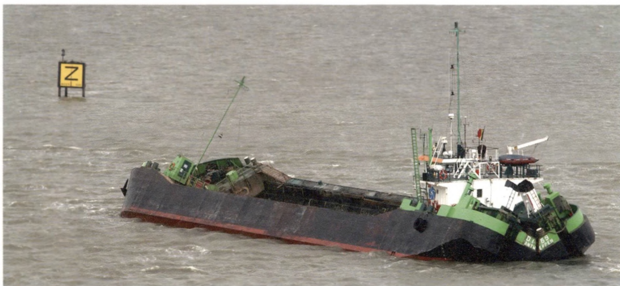
"Een baggerpraam op de Schelde. Merk hoe de hele boot in de lengte openklapt om de baggerspecie uit te storten." Foto Dirk Kerstens
