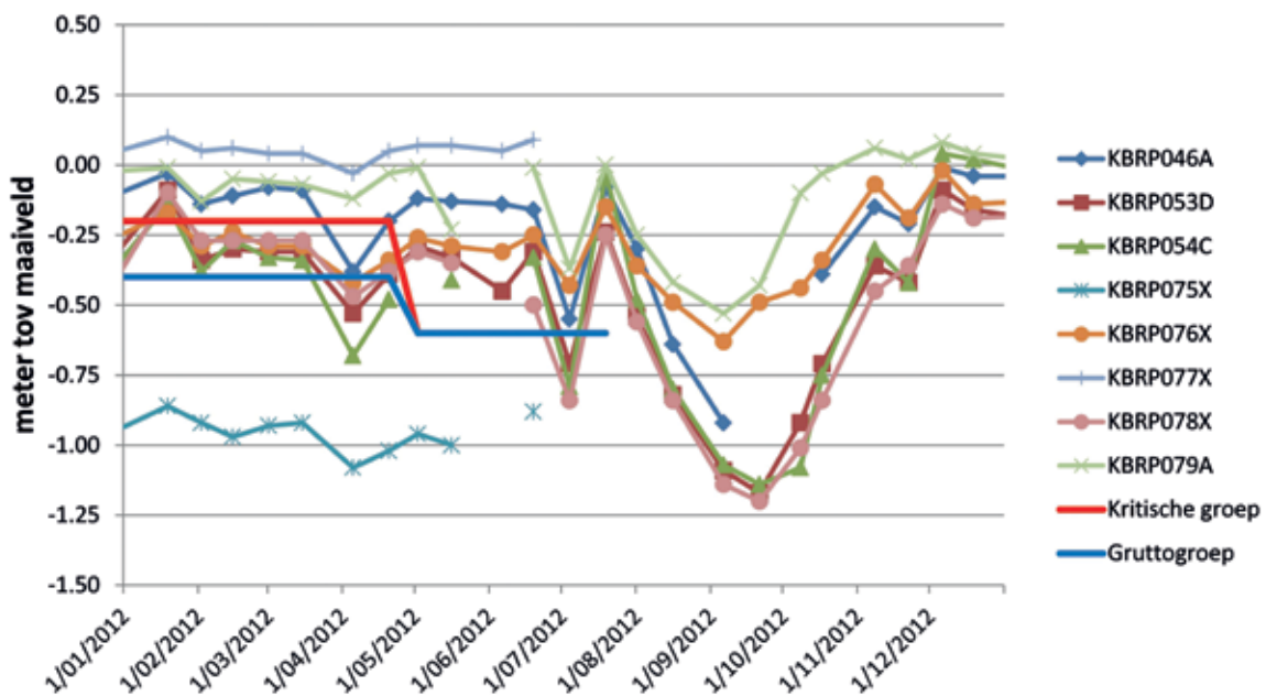
Figuur 7.7: Grondwaterstanden 2012 voor een aantal piëzometers in het weidevogelgebied van Bazel-Zuid (situering in Figuur 7.7). Grenswaarden waaronder het grondwaterpeil niet mag dalen in het broedseizoen (Oosterveld & Altenburg 2005): rode lijn voor kritische soorten (zomertaling, watersnip); blauwe lijn voor minder kritische soorten (grutto, Kievit).
