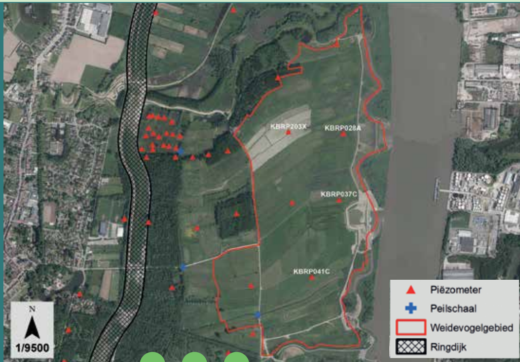
Figuur 7.4: Situering van de piëzometers en peilschalen in het weidevogelgebied van Bazel-Noord
