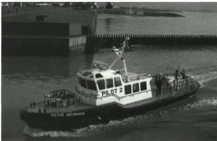
1995: Redeboot nr 2 «Pieter Deconinck» zusterboten zijn nr 1 «Jan Breydel» en nr 3 «Guido Gezelle» L = 22,7m; B = 5,54m; diepgang 1,60m; snelheid 14 knopen. (In 2004 is er opnieuw een ander type bijgekomen de «Rubens»; 18 knopen).
