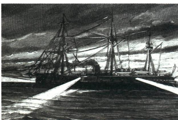
Suite aux progrès enregistrés dans le domaine de l'optique, de puissants projecteurs seront mis au point, permettant le balayage des flots par des faisceaux lumineux intenses. Le puissant éclairage fourni par la lumière électrique permet de scruter au loin l'horizon, et de reconnaître tout navire suspect.
