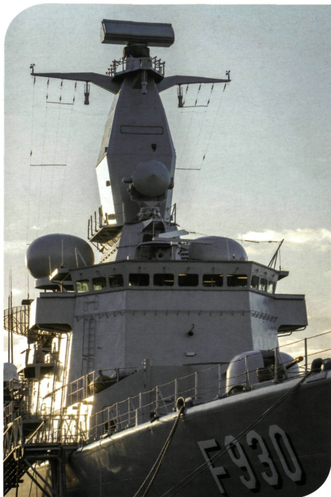
Le nouveau mât du Léopold I, comprenant un Gatekeeper et un Seastar (photo: Jorn Urbain)
