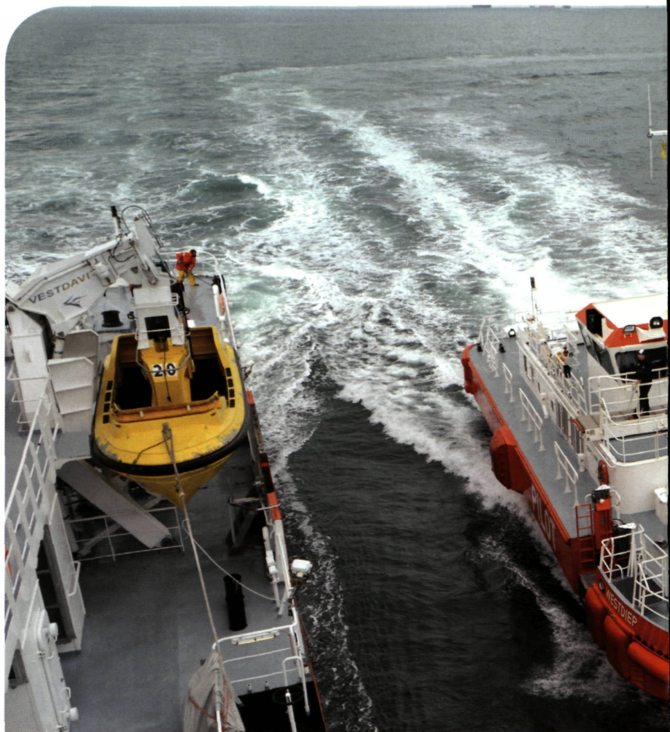
de SWATH Westdiep langsij het moederschip Wandelaar - © Sandra De Canck / Loodswezen
