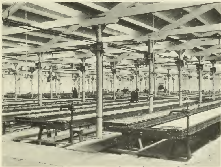
Electrolyse du chlorure de sodium. — Salle des cellules, système Solvay et Cie.
