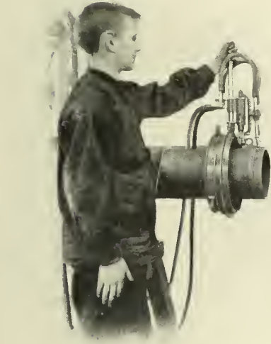
Découpage d'un tube d'acier au moyen d'un jet d'oxygène sous pression.
