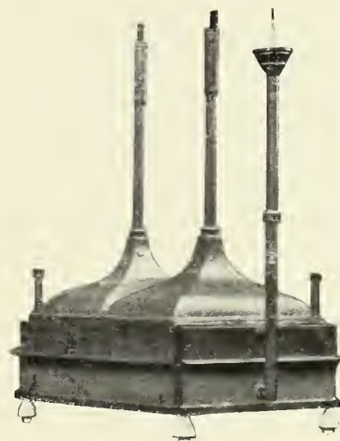
Electrolyseur Garuti muni de deux entonnoirs pour recueillir l'hydrogène et l'oxygène.
