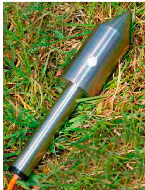
GeoBeads® multi-sensormodule met sondeerpunt
