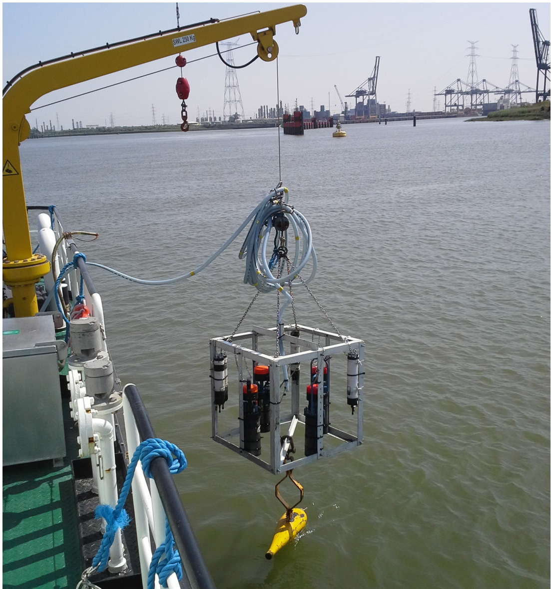
Figuur 2-1 Ijkingsframe met gemonteerde sensoren en zicht op CDW.
