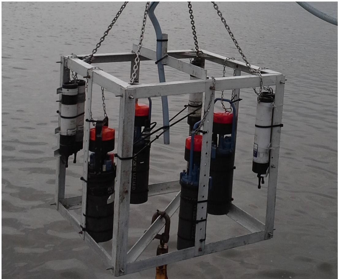
Figuur 2-2 Detail meetframe met gemonteerde toestellen en zuigmond
