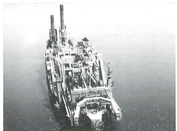
baggeren overdiepte in Waaslandhaven met cutterzuiger
