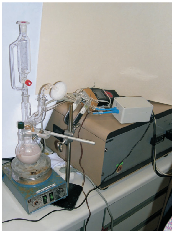
Abbildung 2: Apparatur zur Bestimmung von CO in Fisch im Original - Picture of the equipment for the detection of CO
