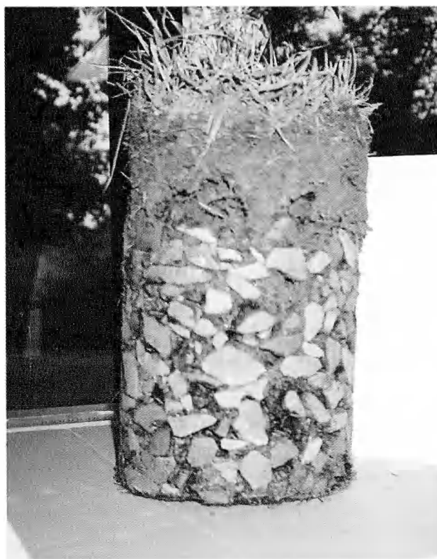
Foto 20. — Doorsnede van de combinatie geotextiel/gevezelde open steenasfalt/teelaarde/begroeiing.
