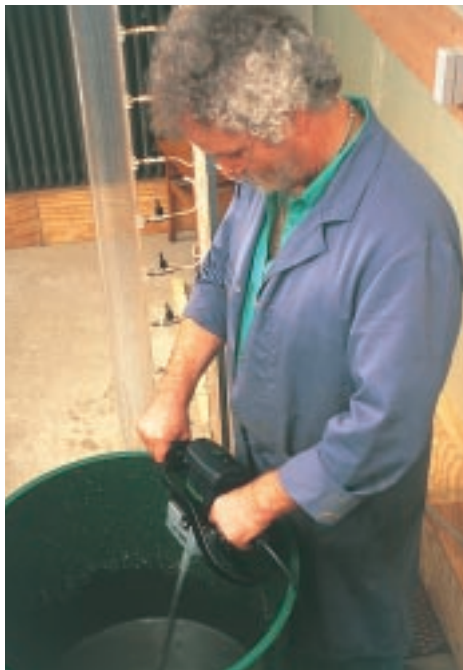
Vooraleer een consolidatieproef kan plaatsvinden, dient het slib in het laboratorium te worden gehomogeniseerd (JB)
