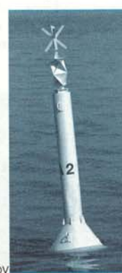
De pilaarvormige sparboei 'A2' is een voorbeeld van een speciale betoning
