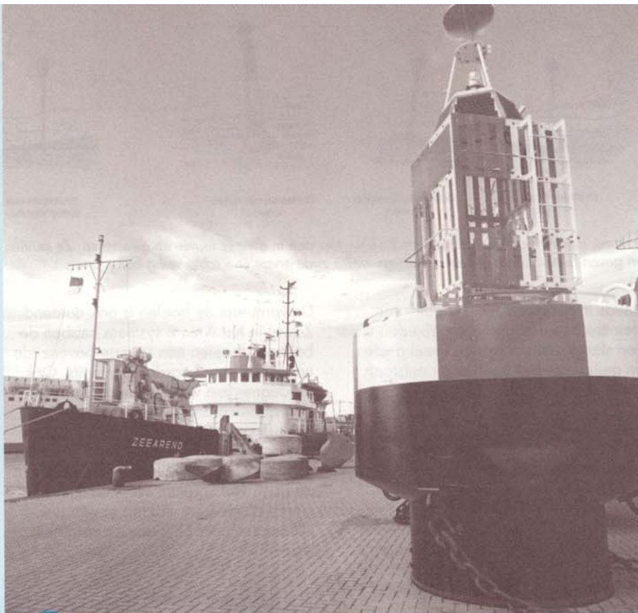
DAB Vloot zet voor het beboeien en bebakenen in de Belgische territoriale wateren de 'Zeearend' in. De Zeearend is voorzien van een werkjol om personeel naar en van de boeien te brengen voor kleine reparaties, en is het enige vaartuig aan de kust dat geschikt is om op een efficiënte wijze boeien op te nemen en uit te zetten d.m.v. zijn kraan
