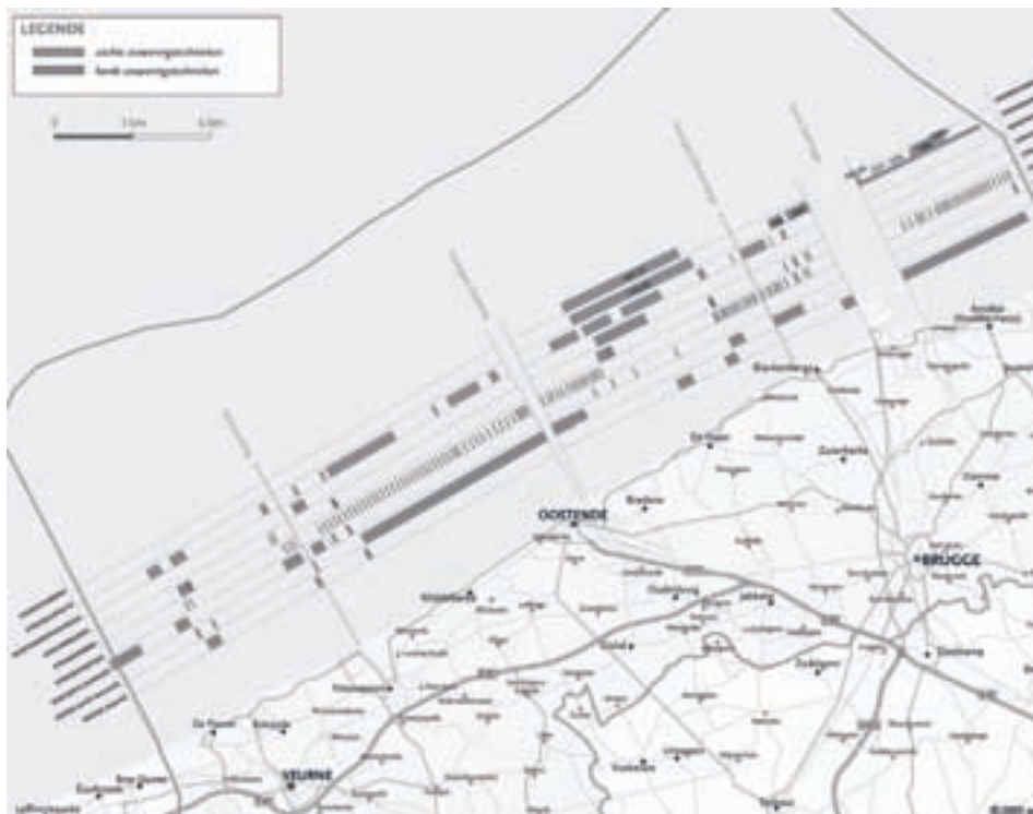
Overzicht van de kustverdedigingsmaatregelen in Vlaanderen, zoals geïnventariseerd in 2005. In de horizontale vensters zijn van boven naar onder weergegeven: (1) vooroeverbermen; (2) strandsuppleties; (3) badstrandophogingen; (4) longardbuizen; (5) strandkribben; (6) strandhoofden; (7) versterkte duinvoet; (8) zeedijk (actief zeewerend); (8) zeedijk (slapend) (Kustatlas 2005)
