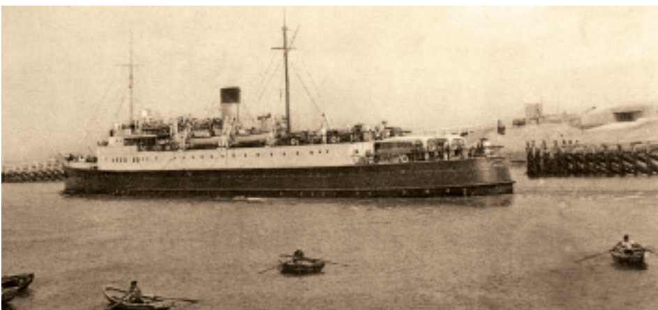
■ In 1935 besloot men om de Ville de Liège om te bouwen tot een 'auto carrier'. Het vaartuig kreeg een ander uitzicht en had maar één schoorsteen meer. In augustus 1936 kwam het opnieuw in dienst onder de naam London-Istanbul . Het kon 250 passagiers en 100 personenwagens vervoeren (AG)
