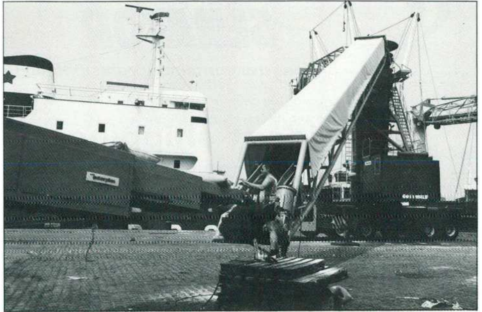
Op de terminal van Belgian Bunkering and Stevedoring Cy aan het Derde Havendok worden de zakken met suiker via spiraalzakbeladers aan boord gebracht.
