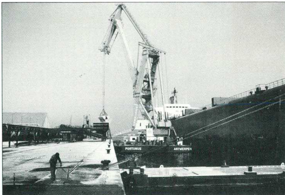
De drijvende grijperkraan « Portunus » ingezet voor het lossen van zwavel aan de terminal van Duval Sales International.
