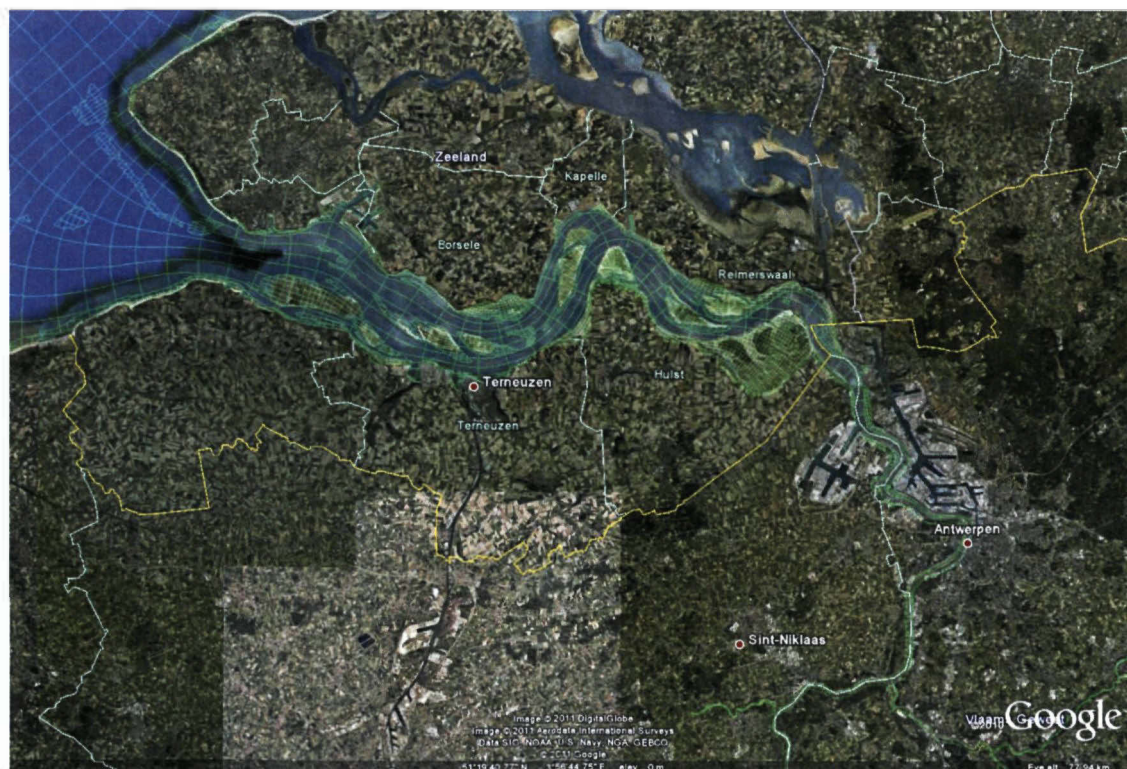
Voorgesteld modelgrid voor waterkwaliteit en ecologie binnen het estuarium bestaande uit 4 x4 aggregatie boven de -5.00 m + NAP dieptelijn en 16 x16 aggregatie onder dit niveau
