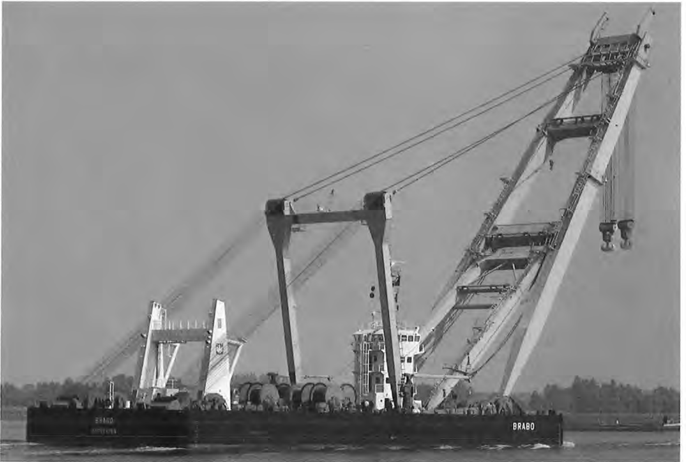
La bigue flottante «Brabo» de 800 tonnes.
