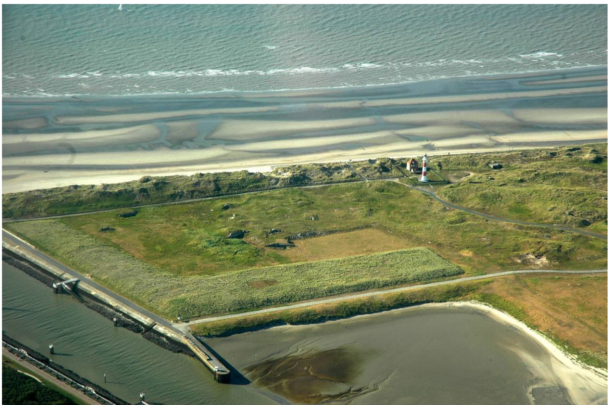
Figuur 32e – De beheereenheden noord en strand-zeereep en de site-vuurtoren met duidelijk beeld van het aangelegde helmduin, de achterliggende geëgaliseerde duinzone en de niet geëgaliseerde duinen tussen helmduin en vuurtoren vanuit de lucht op 23 juli 2006, 18:30 uur (1 uur voor laagwater).
