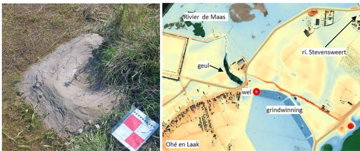
Figuur 4.5: Links: zandmeevoerende wel bij de St. Annakapel na het hoogwater. Het afgezette zand is relatief fijn. Rechts: maaiveldniveau in de omgeving van de wel (AHN3), de dijken zijn aangegeven met een groene lijn – de dijk nabij de wel loopt van de linkerrand iets onder het midden naar de rechterbovenhoek en de andere dijk ligt in de rechteronderhoek.
