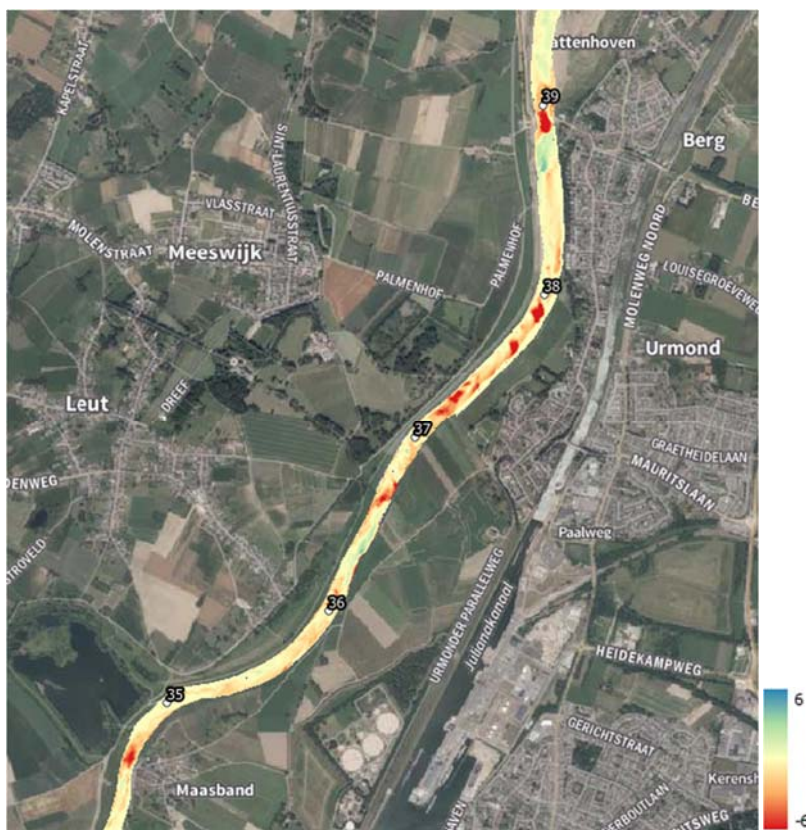
Figuur B.3.1.1: Bodemhoogteverandering tussen rkm 34 en 39 op de Grensmaas. De ontgrondingskuilen hebben dieptes tot meer dan 10 m.
