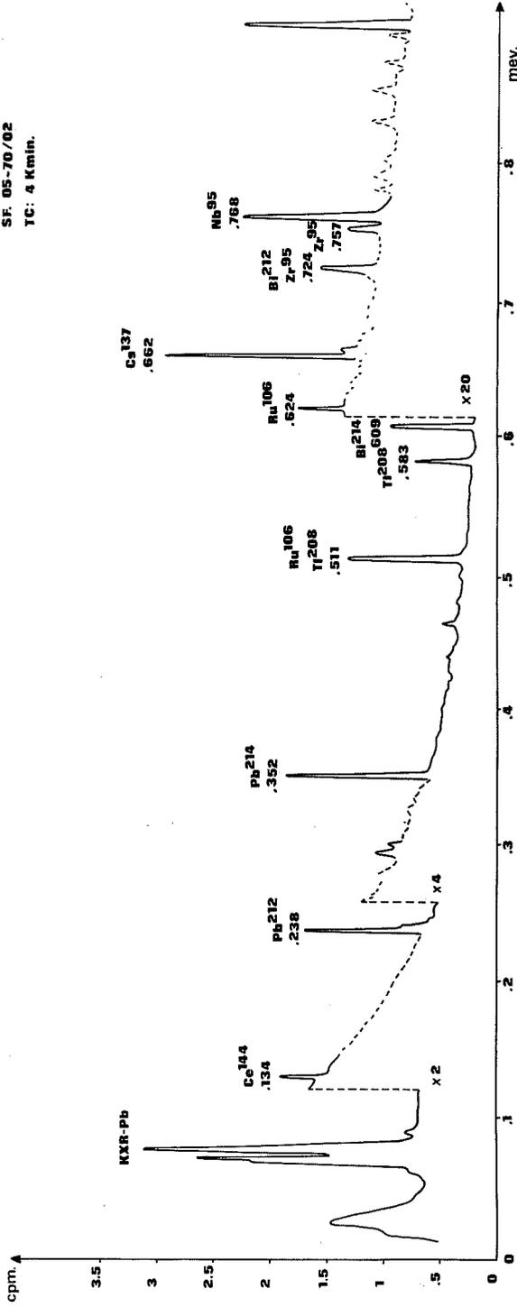
Fig. 2. — Spectre gamma des matières en suspension retenues sur les filtres provenant de la station Zandvlietsluis au niveau de Lillo dans l'estuaire de l'Escaut. Marée haute.
