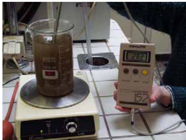
Figuur 6.3: De troebelheid per staal wordt gemeten met het draagbare toestel van Analite type 152 (a) en met het labo toestel van het merk Hach type 2100AN (b).
