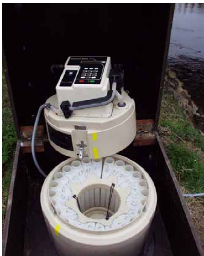
Figuur 5.13: Het staalname-apparaat is ondergebracht in een houten kast. Men ziet hier het reservoir, met de 24 flessen, en daar boven het gedeelte met de elektronische stuureenheid.
