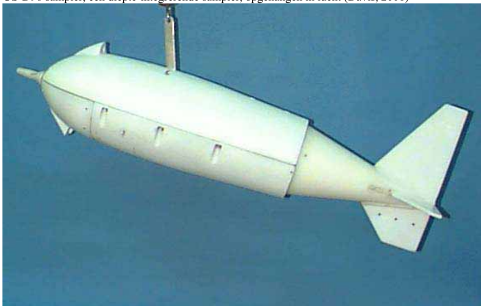
Figuur 7.1: US-D96 sampler, een diepte-integrerende sampler, opgehangen in lucht (Davis, 2001)
