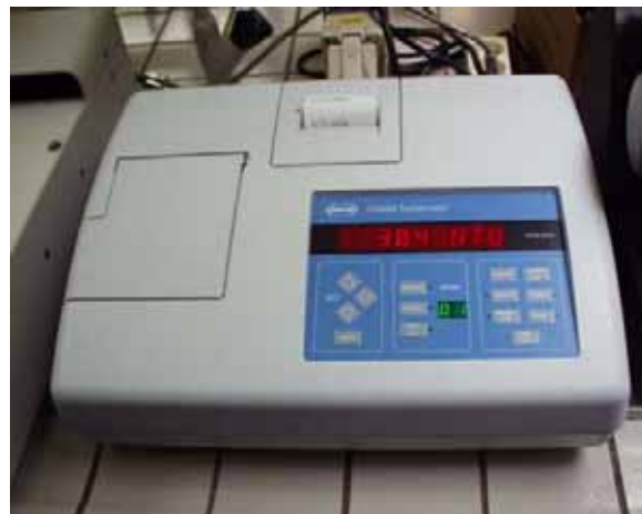
Figuur 6.3: De troebelheid per staal wordt gemeten met het draagbare toestel van Analite type 152 (a) en met het labo toestel van het merk Hach type 2100AN (b).
