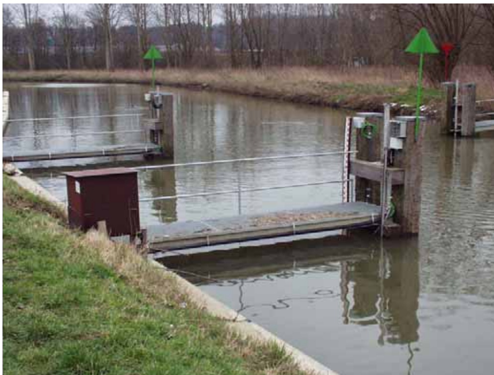
Figuur 5.11: Het staalname-apparaat werd in een houten kast geplaatst op de oever juist naast de loopbrug.
