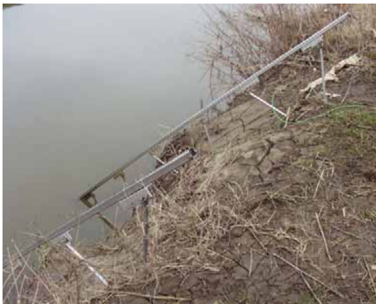
Figuur 5.6: De geleidingsrails voor de sonde en de sampler werden met roestvrije buizen aan de schuine kant van de oever vastgemaakt.
