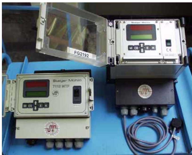
Figuur 6.7 Op de foto rechts het oude model, links het nieuwe. De troebelheidsmeter (of monitor) van het merk STAIGER MOHILO Type 7100 MTF werd geleverd voor voedingsspanningen van 220V AC en voor 24V gelijkspanning.
