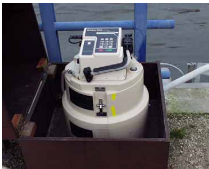
Figuur 5.8: De sampler werd ondergebracht in een houten kast, ter bescherming tegen de weersinvloeden en vandalisme.
