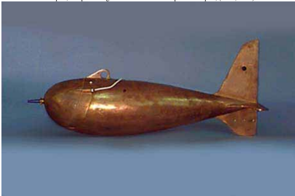
Figuur 7.3: US P-61-A1 sampler, een punt-integrerende sediment in suspensie sampler, (FISP, 2003)
