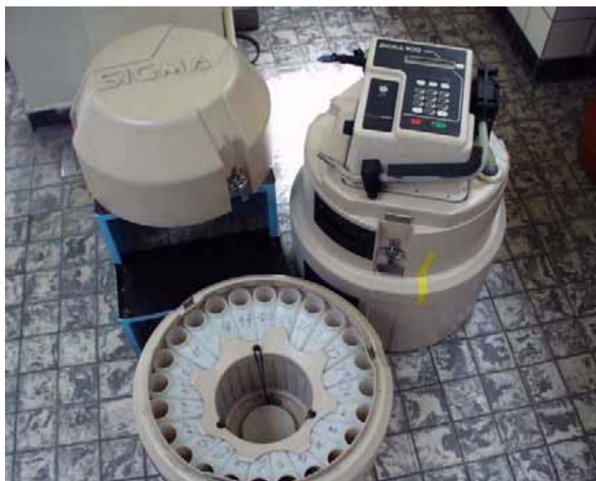
Figuur 6.1: Linksboven de beschermkap van de programmeermodule, rechts de sampler met programmeermodule, onderaan het reservoir met 24 flessen van elk 1 liter.
